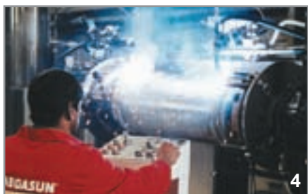
Ρομπότ περιμετρικής συγκόλλησης των δεξαμενών.
