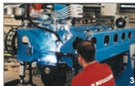
Ρομπότ οριζόντιας συγκόλλησης των δεξαμενών.
