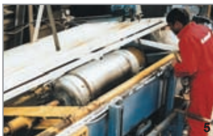
Συγκρότημα δοκιμής πίεσης των δεξαμενών.
